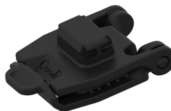
E04-Z-T公扣 此公扣用于肩带处挂水壶及 小包用，5mm，7.5mm，10m m三段厚度可调。夹持宽度 为70mm以内。
